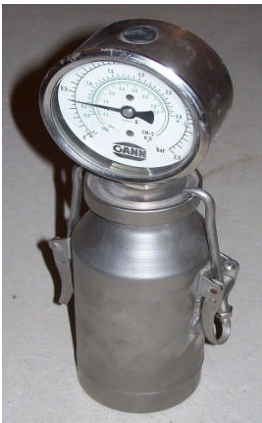
Beim CM-Verfahren eingesetzte Probenflasche mit Manometer
